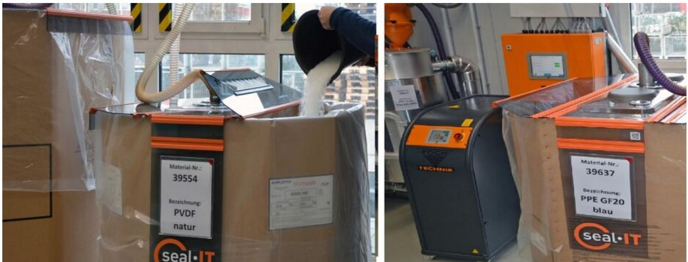
Die Seal-IT-Schüttgutabdeckungen lassen sich zum Nachfüllen einfach öffnen und verfügen über drei Durchstoßeinheiten zum Beschicken von Maschinen. Bilder: Seal-IT / Prominent
